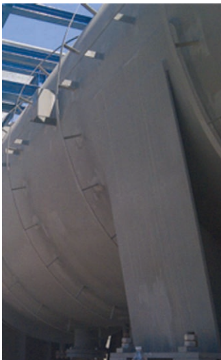
Figura 4.4.1.B. Ejemplo de distanciador en equipo.
