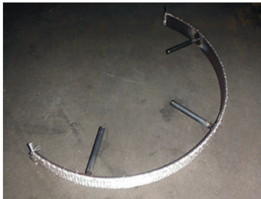
Figura 4.3.1.A. Ejemplo de distanciador para tubería horizontal.
